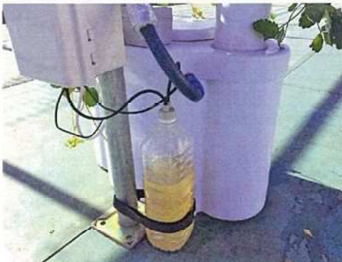
図 5.1.9 タンクへの注水・追肥機構(左)とホースの Y 字分岐ジョイント(右)
