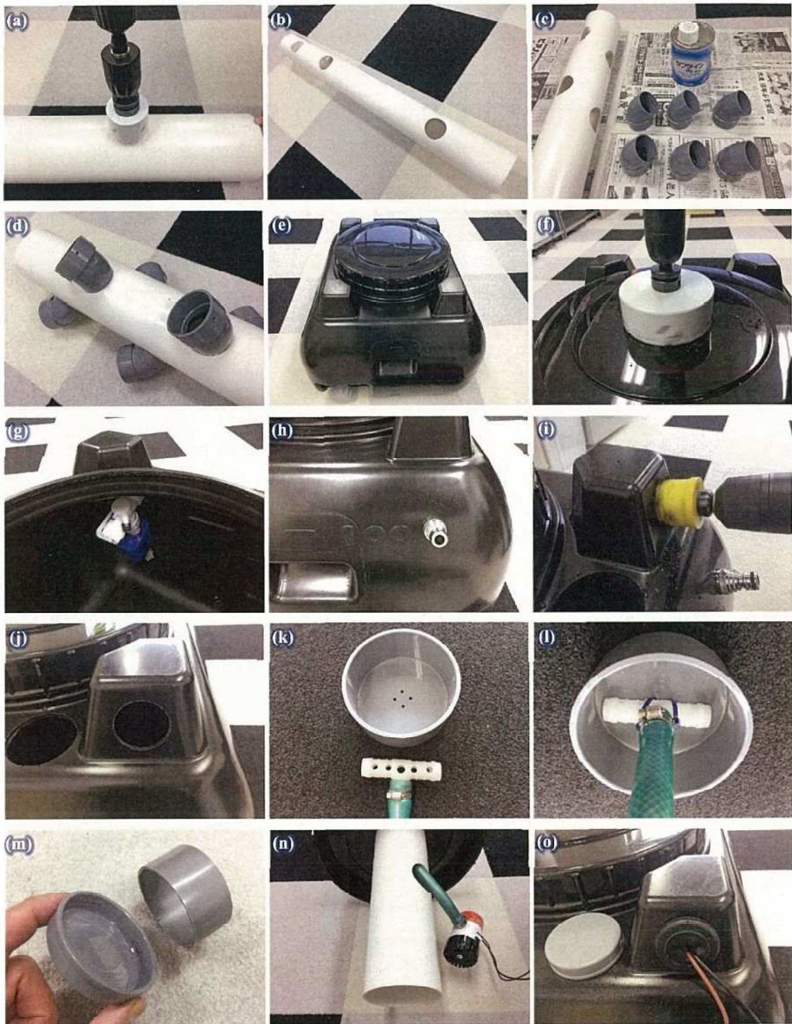
図 6.4.5 実験用水耕栽培装置の制作
