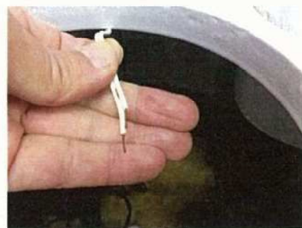
図 5.2.5 水位計測用ケーブル
