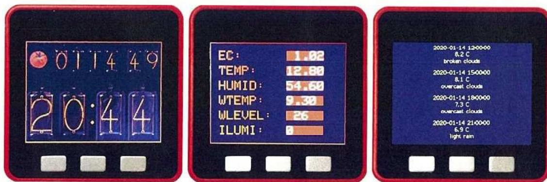
図 5.3.5 M5Stack FIRE の操作画面 (左から、時計、センサデータ、天気情報)
