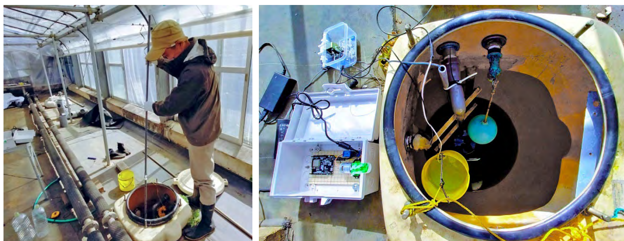
図 6.3.6 フロートスイッチを使った水位制御機構と追肥モジュールの設置
