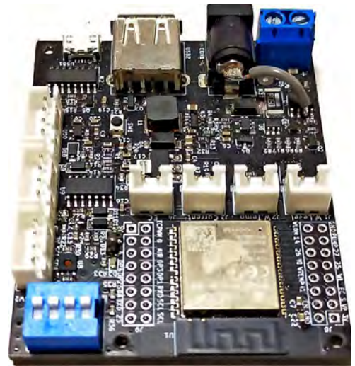
図 6.5.6 Rev.1 基板のリワーク
