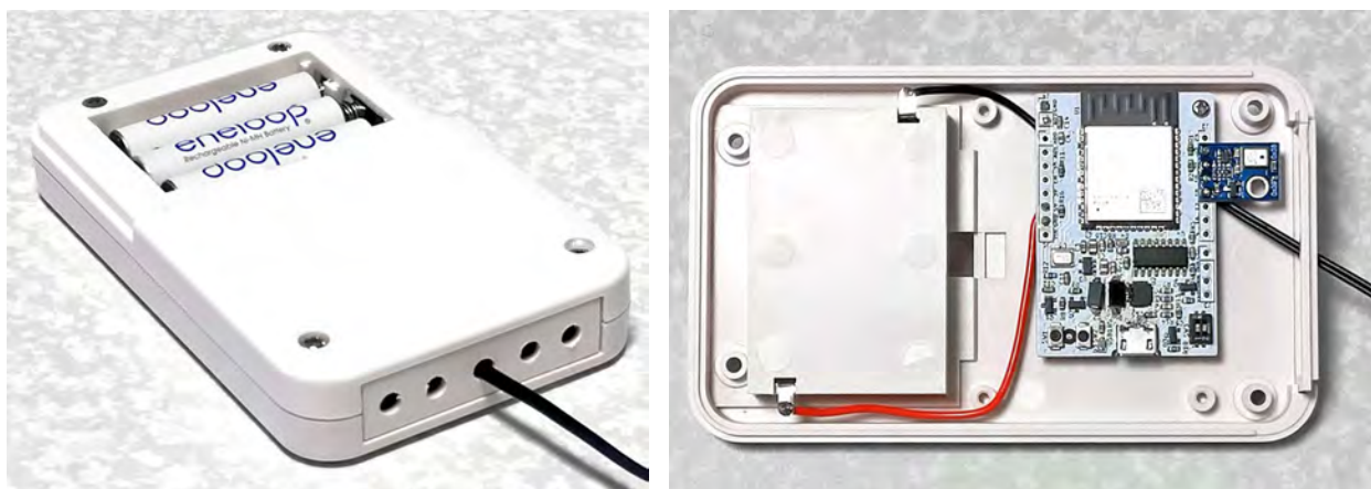
図 6.3.2 温湿度センサモジュール
