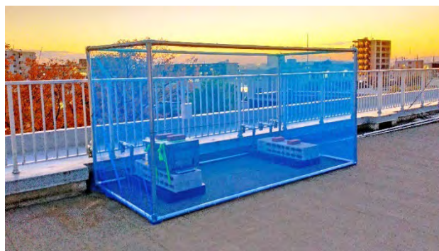
図 6.1.2 フレームの組み立てと防御ネットの設置(11月21日)
