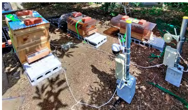
図 6.4.21 野崎果樹園へのネットワークカメラ(左)と清水ファームへの温湿度・重量センサ(右)の導入
