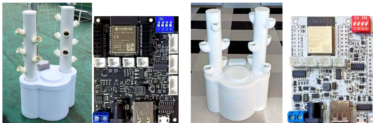
図 5.1.4 小学校で用いた旧型(左)と新型(右)の小型水耕栽培装置とコントローラ
