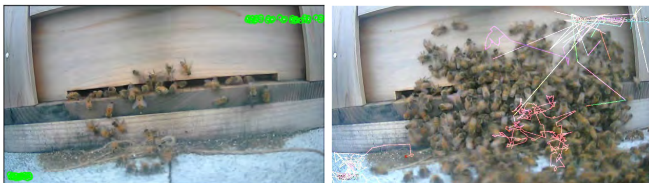
図 6.4.7 Lucas-Kanade 法の Optical flow(スズメバチ襲来 2)
