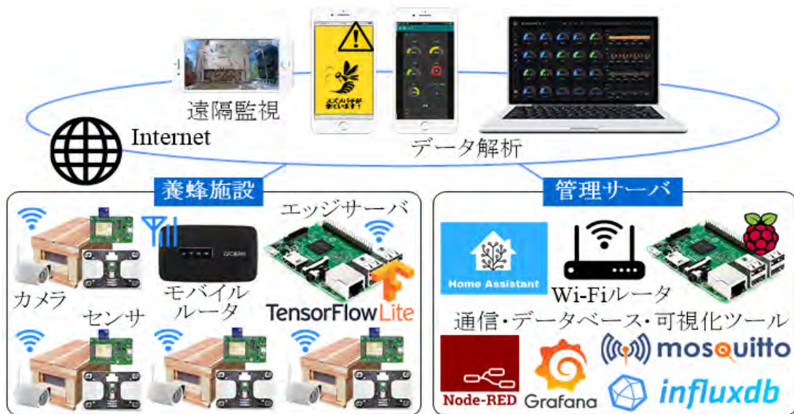
図 6.3.1 スマート養蜂システムの構成
