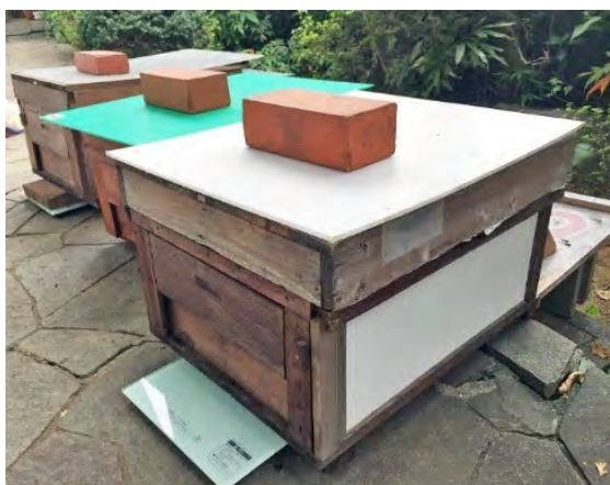
図 6.3.7 セイウミツバチへの重量センサ設置
