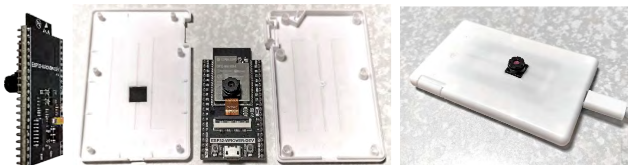
図 6.4.17 ESP32-CAM WROVER のケース封止
