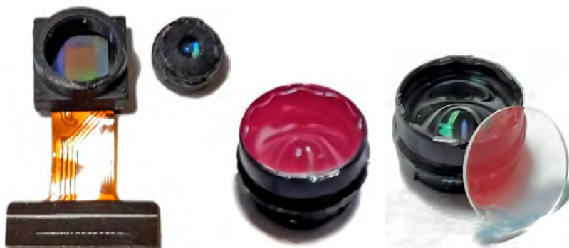
図 6.4.15 赤外線フィルタの除去
