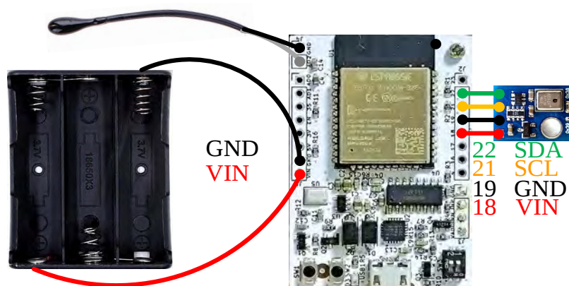
図 6.3.3 温湿度センサモジュールの配線図
