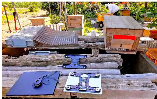
図 6.4.21 野崎果樹園へのネットワークカメラ(左)と清水ファームへの温湿度・重量センサ(右)の導入
