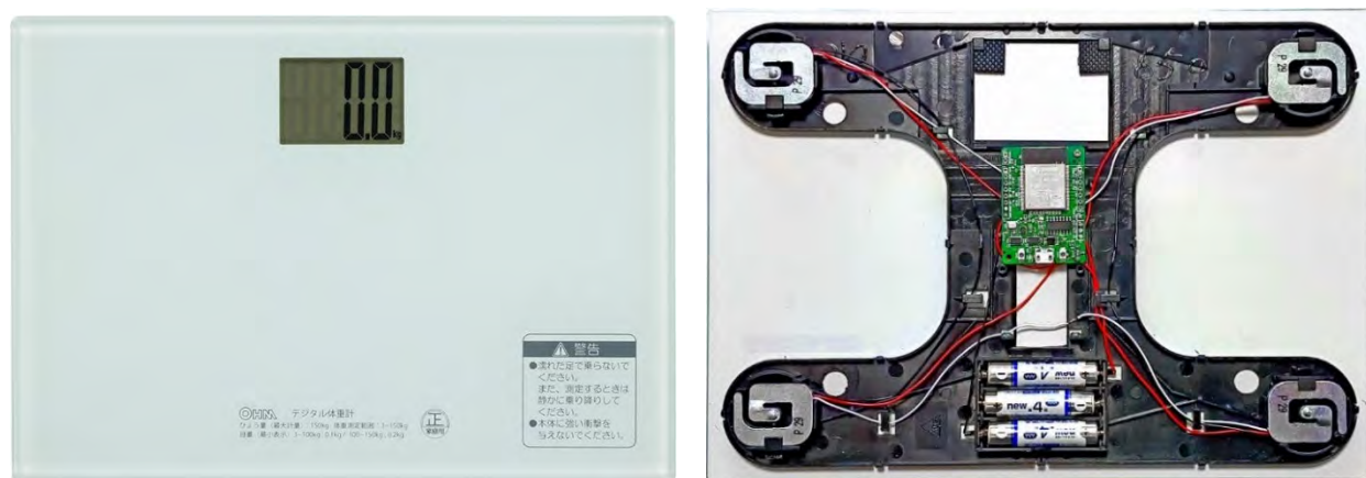
図 6.3.4 デジタル体重計 HBK-T101 の表面(左)と内部にセンサ基板を組み込んだ裏面(右)
