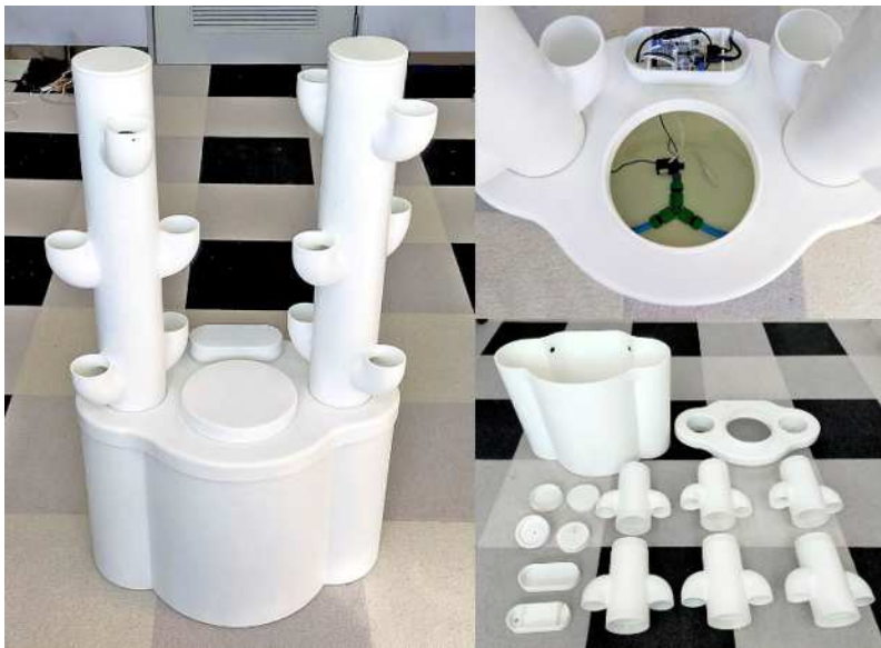
図 6.1 3D プリントで試作した水耕栽培装置の筐体
