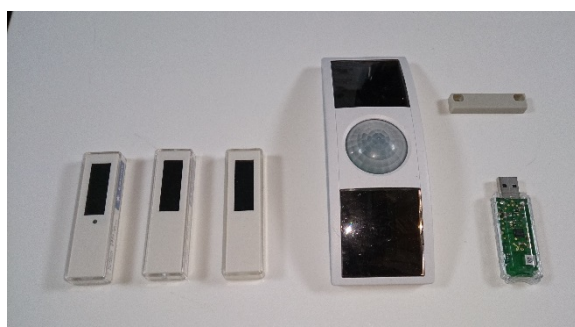
センサー一式（ドア開け閉め・温度湿度・照度・人感・受信機） 図6-8
