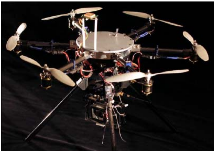
千葉大野波研究室開発 完全自律飛行型マルチコプター 株自律制御システム研究所製 ミニサーベイヤーMS-06
