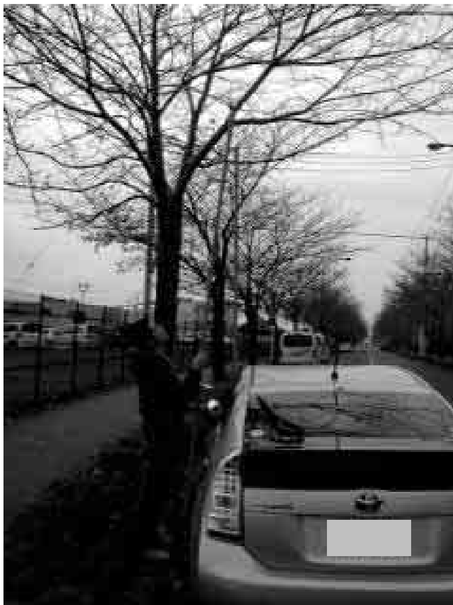
図 5-4-3-3 三鷹市大沢コミュニティ通りにおける街路樹枝葉高さ自動センシングシステムの自動記録時の枝葉高さ確認計量状況 (2010 年 11 月 25 日 14 時 15 分) 曇り
