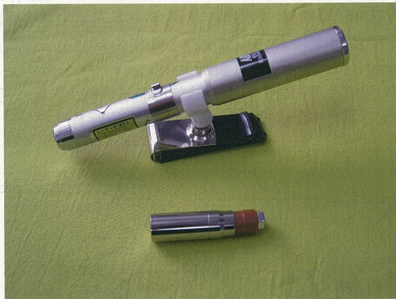
図5-5 姿勢SWの外観 試作S3(写真手前)
