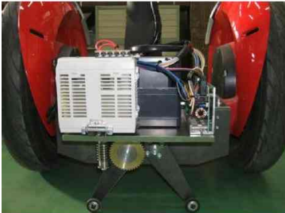
Fig.7 試作した付加装置（回路部およびスタンド部）
