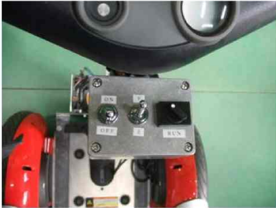
Fig.8 試作した付加装置（操作装置）
