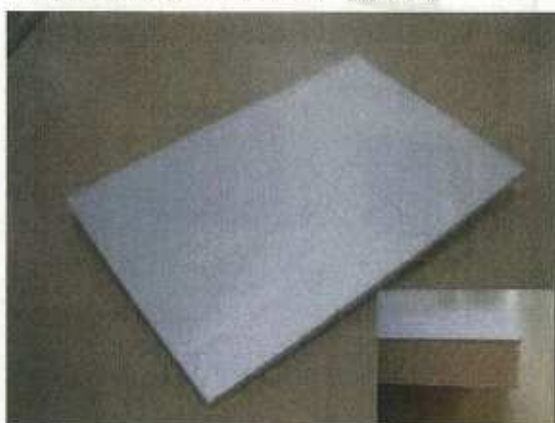
写真 4.3.13 アルミクラフト紙仕様断熱内戸試作品および断熱材断面
