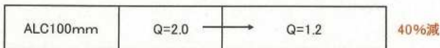
図4.2.2 執務室の熱損失係数計算結果（左ガラスのみ、右断熱内戸設置）[単位 W/m 2 K]
