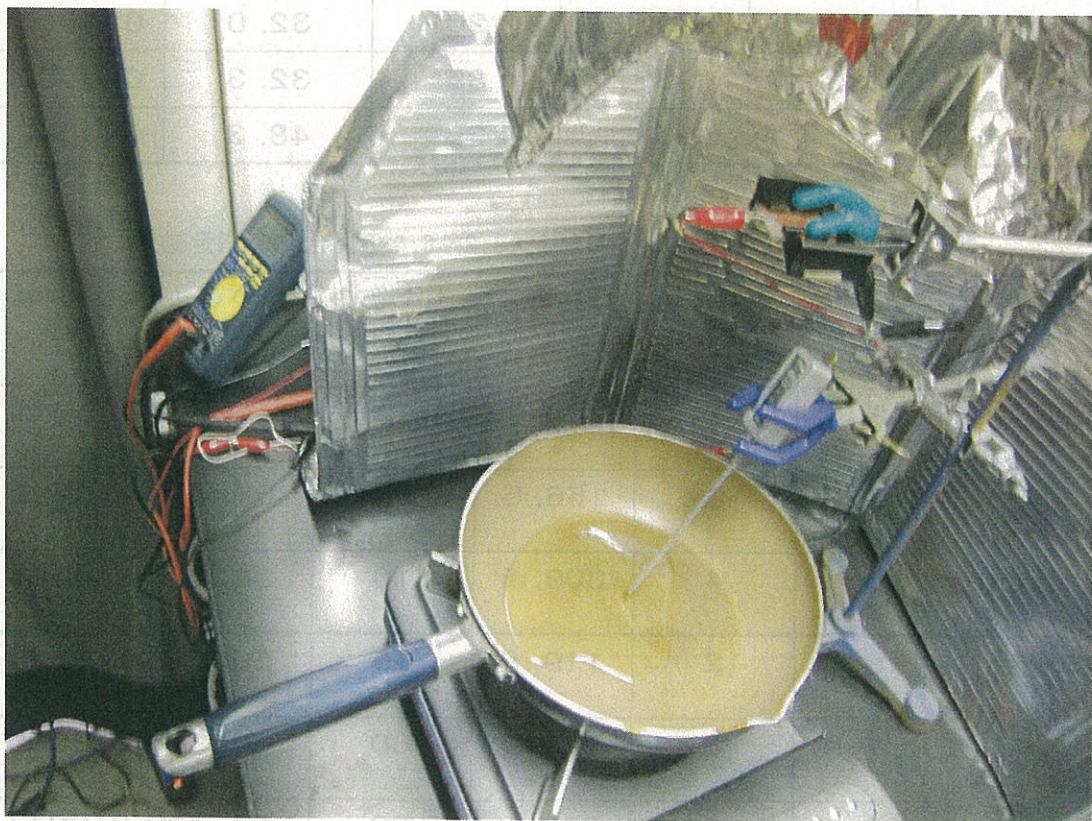
図4-4 実験系の全体図(食用油での匂い測定)
